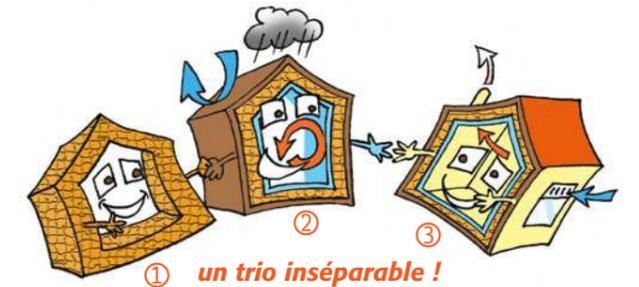
Pour qu'un isolant isole bien, il faut le mettre à l'abri des courants d'air et de l'humidité : c'est le rôle du pare-vapeur (ou freine-vapeur) (en bleu sur le dessin) mis en œuvre contre l'isolant du côté intérieur des parois et celui du pare-pluie (ou sous-toiture) (en brun sur le dessin) posé contre l'isolant du côté extérieur.
