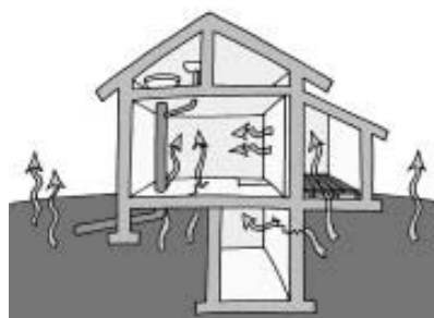
Dans un bâtiment, les voies d'entrée du radon sont souvent multiples.
