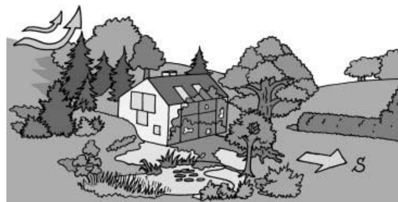
Sous nos climats, le site « idéal » est un terrain en pente légère vers le sud.
